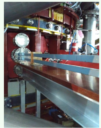
चित्र 11: आदित्य-यू पर समर्थन संरचना पर स्थापित रिफ्लेक्टोमेट्री प्रणाली
